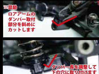
※奨励は車高調 (プリロード) 付のダンパーを使用し、ロアアームの下穴に取り付けてください。
