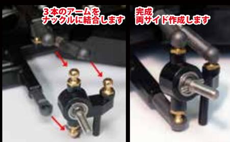
左右のナックルを結合します。ナックルは左右がありますので向きを確認してください。
