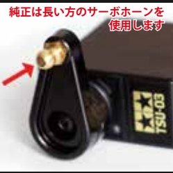
他メーカーのサーボに付属、またはアルミの薄いサーボホーンを奨励します。プロポのステアリングがフルで使える位置にサーボロッドを取り付けます。
