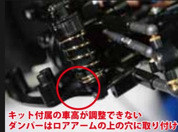
※奨励 ロアアームのダンパー取付部分を斜めにカットします
