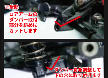
キット付属の車高が調整できないダンパーはロアアームの上の穴に取り付け
