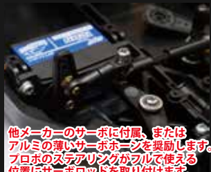
純正は長い方のサーボホーンを使用します
