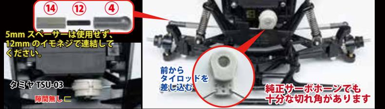
5mm スペースサーボは使用せず、12mmのイモネジで連結してください。
