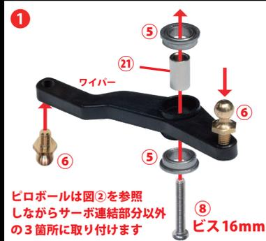
ピロボールは図②を参照しながらサーボ連結部分以外の 3箇所に取り付けます
