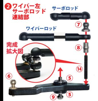
左右のワイパーを作成します。ピロボールは上から、ビスは下から差し込みます。
