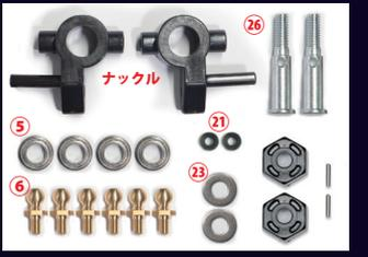
ナックル両面からベアリングを入れ、裏面からアクスルを入れます。指定の位置にスパーサーを入れ、ピロボールを取り付けます。左右1つずつ作ります。
