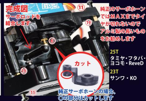
純正のサーボホーンではMAXまでタイヤが切れないのでアルミ製の長いものをお勧めします
