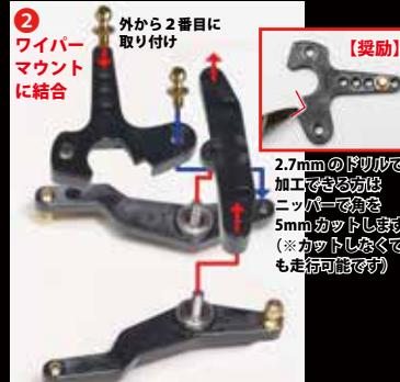
2.7mm のドリルで穴を開け加工できる方はニッパーでねじを 5mm カットします(※カットしなくても走行可能ですが)
