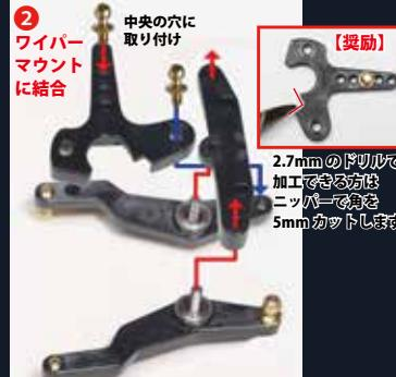
左右のワイパーを作成します。タイロッドは吊り下げ式になりますので向きに注意してください。
